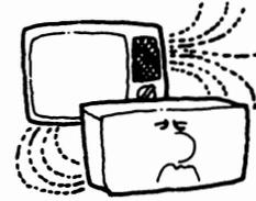
湿度の高い所や、冷たい所から急に暖かい所へ移動しますと製品に露がつく場合があります。露がつくと製品の動作に悪影響を与え、故障の原因となりますので、よく乾燥させ、露をよく取り除いてからご使用ください。
