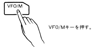
30チャンネルに下限および上限周波数をメモリーさせると、その範囲内でプログラムスキャンを行います。(4-4-4. 3. 区間指定メモリーチャンネル) また、下限および上限周波数を入れ換えると、低くなる方向にスキャンします。
