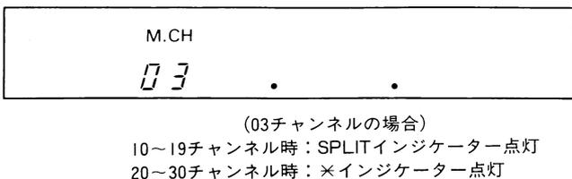
4. 再び, M. INキーを押しますと, メモリースクロール状態が解除(M. SCRインジケータ消灯)され, 指定されたメモリーチャンネルに1. で指定した周波数およびモードがメモリーされます。
