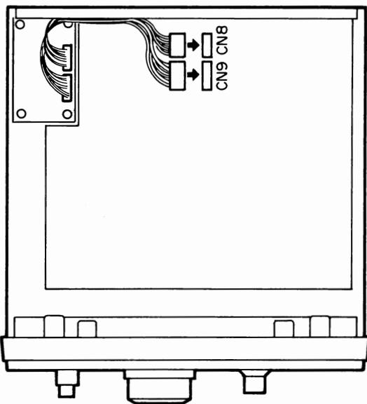
4. セット背面のACC1に付いているコネクターカバーのつめを押しながら外側へ押し、外します。
