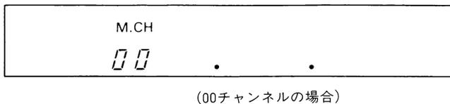
3. メモリースクロール状態(M. SCRインジケータ点灯)となり, メモリーチャンネルをM. CH/VFO CHつまみにより指定します。
