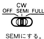
SEND/RECスイッチを押さなくても、キーダウン(キーを押す)すれば自動的に送信状態になり、キーアップ(キーを上げる)しても一定時間(背面パネルのDELAYつまみで可変できます。)は送信状態が保持され、その後、受信状態に戻ります。
