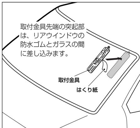
4. 取付金具を貼り付けたあと24時間以上放置します。この間、取付金具に水をかけたり力を加えたりしないように注意してください。
