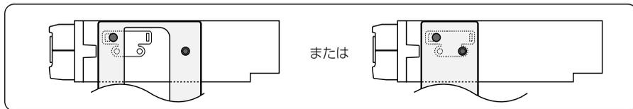
車両ブラケットが上図の形状の場合、本機の左右2ヶ所ずつをネジで固定できません。以下のように金具⑩を使用してブラケットを固定してください。
