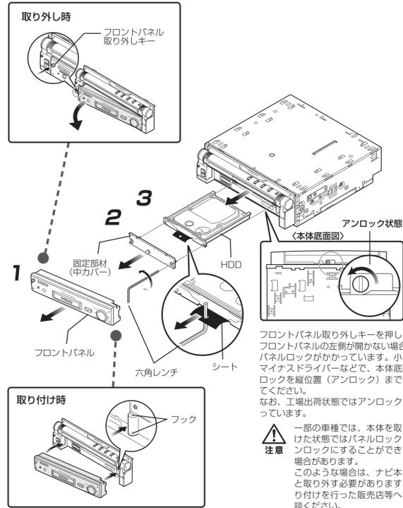
フロントパネル取り外しキーを押してもフロントパネルの左側が開かない場合は、パネルロックがかかっています。小さなマイナスドライバーなどで、本体底面のロックを縦位置（アンロック）まで回してください。なお、工場出荷状態ではアンロックになっています。
