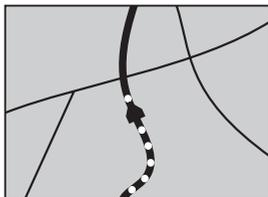
本機は、GPS と自律航法を併用して精度の高い測位を行った上でマップマッチング機能が動作するため、より正確な現在地を表示することができます。
