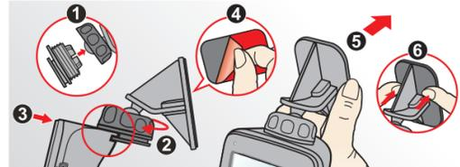
取り付け位置を確認して取り付けます。粘着テープの取付強度を強くするため、取付後24時間以上放置してから使用してください。
