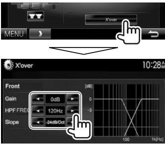
**<Gain>** Ajuste le niveau de sortie de l'enceinte sélectionnée.
