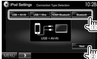
**[USB + AV-IN]** Sélectionnez ce réglage quand l'iPod/iPhone est connecté en utilisant le KCA-iP202 (en option).
