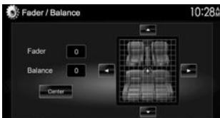
**Fader** : Ajustez la balance de sortie avant-arrière des enceintes.
