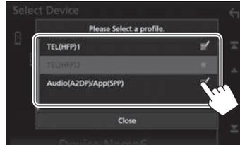
Bei jedem Berühren der Auswahl wird die Verwendung gewählt („✓“ erscheint) oder die Wahl aufgehoben („✓“ verschwindet). Zum Verbinden des Geräts wählen und zum Abtrennen des Geräts freigeben.
