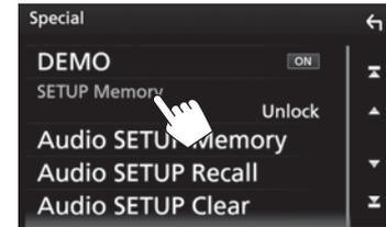
**Zum Lösen der Einstellung:** Berühren Sie [SETUP Memory], um [Unlock] zu wählen.
