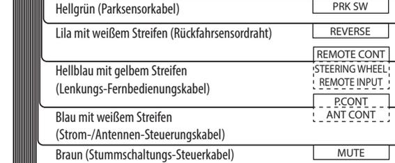
Schließen Sie dies an den Rückfahr Lampenkabelbaum an, wenn die optionale Rückfahrkamera verwendet wird.
