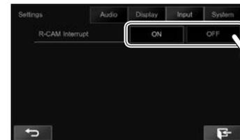
[ON] Zeigt das Bild von der Rückfahrkamera an, wenn der Rückwärtsgang (R) eingelegt wird.
