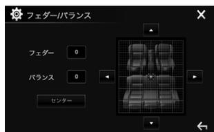
**フェダー**：フロントスピーカーとリアスピーカーの出力バランスを調整します。
