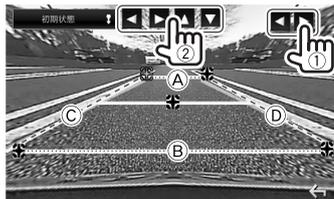
①と②が水平方向に平行に、③と④が同じ長さになるようにします。
