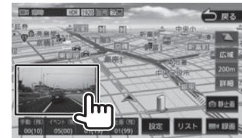
一定時間操作が無いと一部の操作ボタンが消えます。タッチすると再度表示します。
