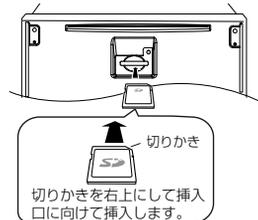
挿入したらフロントパネルの【▲】（オープンキー）押してパネルを閉じます。
