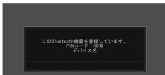
初期設定は“0000”に設定されています。Bluetooth 機器によっては、PIN コードを入力するときに、この画面が表示されていないことがあります。その場合は、本機の PIN コードを確認してから Bluetooth 機器に入力してください。
