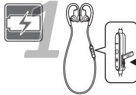
●故障や異常発熱の原因となりますので、USB変換ACアダプター(市販品)は、必ず出力電圧がDC5Vのものを使用してください。
