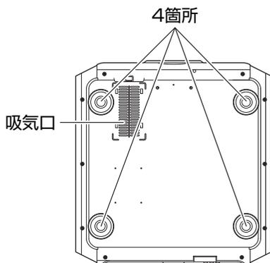
底面のフット 4 個をはずし、ネジ (M5 ネジ 13~23 mm) で止める。
