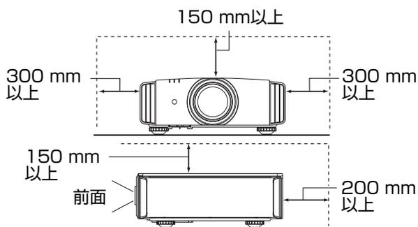
前面は開放してください。前面に遮蔽物があると排気口からの熱風が逆流して本体を加熱したり、排気の熱い空気による影がスクリーン上に映ったりする(陽炎現象)ことがあります。
