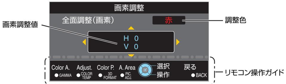
⑥ 調整が終わったら、[BACK]ボタンを2回押して調整モードを解除する
