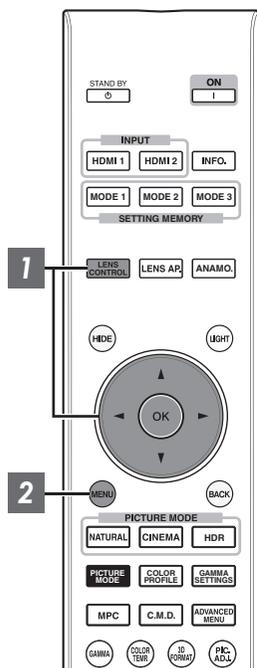
1 [LENS CONTROL]ボタンを押し、[▲▼◀▶]キーでフォーカス(焦点)、ズーム(画面サイズ)、シフト(画面位置)を調整する
