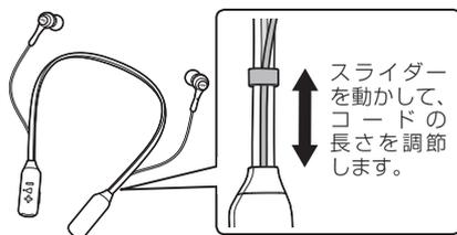
スライダーを動かして、コードの長さを調節します。
