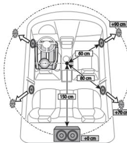
現在選んでいるリスニングポジションからすべてのスピーカーまでの距離を指定すると、以下の手順でディレイタイムが自動的に計算され設定されます。
