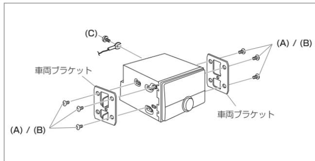
本機の取り付け時の傾斜角度は $30^{\circ}$ 以下になるように取り付けてください。 $30^{\circ}$ 以上の角度で取り付けると音飛びの原因となります。
