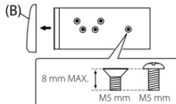
▲ 僅使用指定的螺絲。使用不正確的螺絲可能損壞本機。
