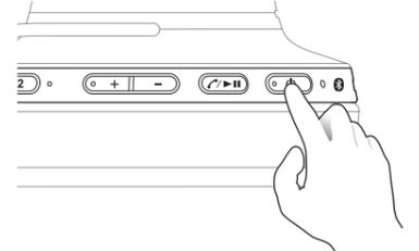
相手機器側の BLUETOOTH 機能を ON にした状態で、本機のボタンを 3 秒間押し続けてください。インジケータが青色にゆっくり点滅し、最後に使っていた機器と自動で接続されます。
