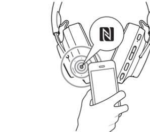
相手機器側の BLUETOOTH 機能を ON にした状態で、本機と相手機器をタッチさせると、本機の電源が入ります。相手機器の画面の指示にしたがって接続してください。
