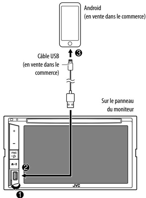
Lors de la connexion d'un périphérique Android, "AUDIO MODE" apparaît. Vous pouvez commander un périphérique Android en utilisant une application du lecteur multimédia installée sur le périphérique Android.
