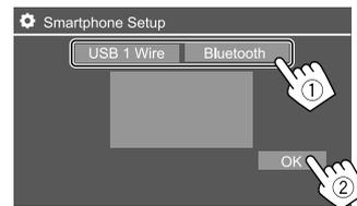
**[USB 1 Wire]** Sélectionnez ce réglage quand le périphérique est connecté via la prise d'entrée USB sur le panneau du moniteur.
