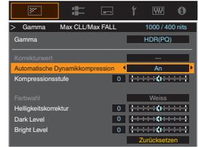
**3** Konfigurieren der Grundhelligkeit in „Kompressionsstufe“
