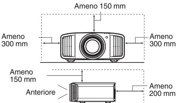
Lasciare libera la parte anteriore dell'unità. Se vi sono oggetti che ostruiscono la ventola di scarico, l'aria calda tornerà indietro nell'unità provocandone il riscaldamento. L'aria calda che fuoriesce dall'unità potrebbe proiettare ombre sullo schermo (fenomeno della foschia da calore).
