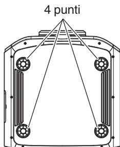
Rimuovere i quattro piedini nella parte inferiore e fissarlo con le viti (viti M5, da 20 a 25 mm).
