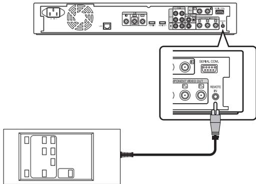
Die Benutzung eines Kabels ermöglicht die stabile Steuerung dieses Geräts über ein externes Gerät. Unabhängig von den Fernbedienungscodeeinstellungen im Gerät kann die Bedienung über einen beliebigen Code (1 bis 4) erfolgen.
