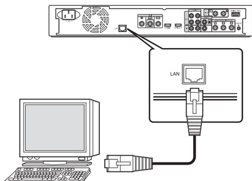
Die externe Bedienung kann durch Anschluss an einen PC oder ein ähnliches Gerät per LAN-Kabel aktiviert werden. Für ausführliche Informationen zur externen Bedienung siehe „Externe Steuerung“ (S. 95).
