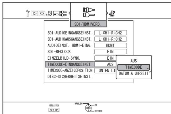
**TIMECODE** : Sind mehrere Timecode-Eingangssignale vom SDI-Gerät vorhanden, werden diese im SDI-Videoeingang überlagert.
