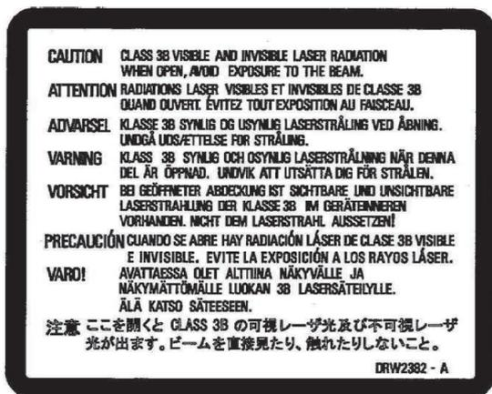
Dieses Gerät entspricht dem Standard IEC60825-1:2007 für Laserprodukte.
