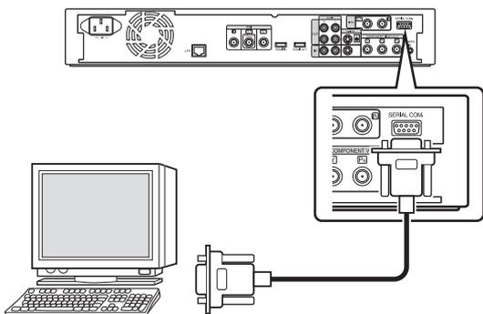
Mittels Anschluss eines RS-232C-Kabels an einen PC oder ein ähnliches Gerät ist die externe Bedienung möglich. Für ausführliche Informationen zur externen Bedienung siehe „Externe Steuerung“ (S. 95).
