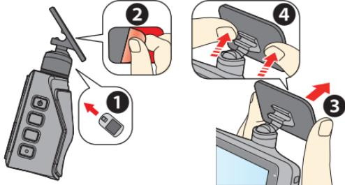
貼り付け位置を確認して貼り付けます。粘着テープの取り付け強度を強くするため、取り付け後24時間以上放置してから使用してください。
