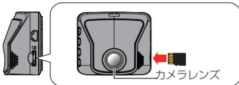
microSDカードを取り出すときは、microSDカードを押してmicroSDカードが少し飛び出たら引き抜きます。
