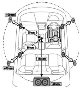
現在選んでいるリスニングポジションからすべてのスピーカーまでの距離を以下の手順で登録すると、ディレイタイムが自動的に計算され設定されます。
