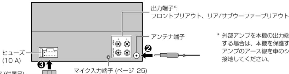
\* 外部アンプを本機の出力端子に接続する場合は、本機を保護するため、アンプのアース線を車のシャーシに接地してください。
