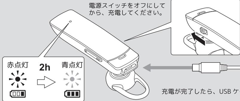
・故障や異常発熱の原因となりますので、USB変換ACアダプター（市販品）は、必ず出力電圧がDC 5Vで、電流が1A以上のものを使用してください。
