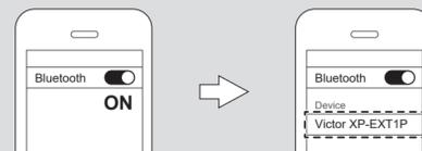
・プロセッサユニットの [BT CONNECTION] インジケーターが白く点灯すれば、接続が完了です。
