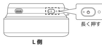
ヘッドホンの電源ボタンを長押しすると電源が切れ、連動してプロセッサユニットの電源が切れます。
