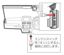
シガープラグコードには12Vから5Vに変換する回路が内蔵されています。 シガープラグコードの改造、加工は故障の原因となりますので、絶対に行わないでください。
