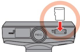
microSD カードのロゴがある面をレンズ側にして、端子面から挿入する
