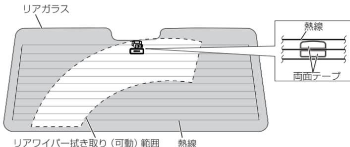
2nd カメラはリアガラス上部の車両中心となる位置への取付を推奨します。後方視界補助ミラー等により推奨位置に取り付けできない場合は、後方急接近警告機能が正しく動作しないため、後方急接近警告機能をオフにしてください。(→ P.45)
