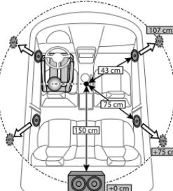
Pokud zadáte vzdálenost od aktuálně nastavené polohy pro poslech ke každému reproduktoru, doba zpoždění se automaticky vypočítá a nastaví.
