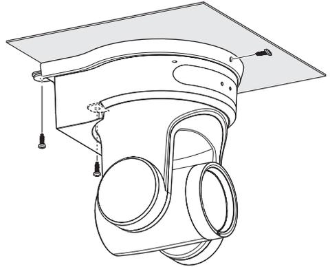
Befestigen Sie den Fallschutzdraht (separat erhältlich) mit einer der Schrauben.
