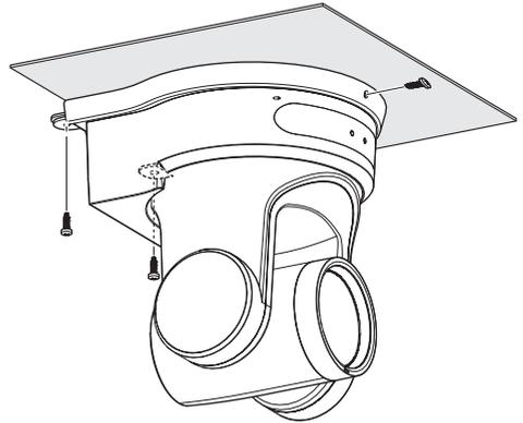
Fije el cable anticaída (vendido por separado) con uno de los tornillos.
