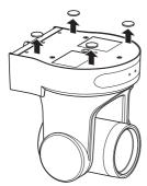
Используйте три винта М3 и один винт 1/4", поставляемые вместе с камерой, чтобы прикрепить кронштейн для установки на потолке (со стороны камеры) к нижней поверхности камеры
