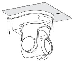
Закрепите трос для предотвращения падения (продается отдельно) с помощью одного из винтов.
