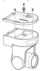
3 Установите камеру на кронштейн для установки на потолке (со стороны потолка)
