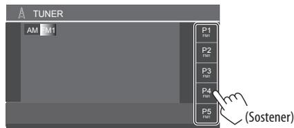
La emisora seleccionada en el paso 1 se guarda en el número de preajuste [P1] a [P5] seleccionado por usted.
