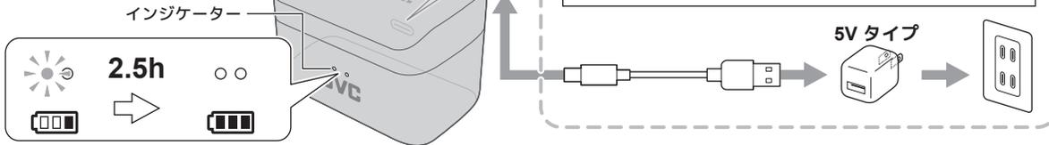
・故障や異常発熱の原因となりますので、USB 変換 AC アダプター(市販品)は、必ず出力電圧がDC5Vで、電流が1A以上のものを使用してください。
