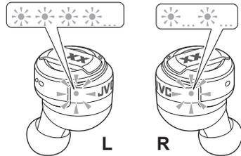
・両方のインジケータがゆっくり 2 回点滅する場合は、両方のイヤホンを一度充電ケースに戻して、約 10 秒たってから、もう一度両方のイヤホンを取り出してください。
