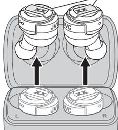
取り出し時にタッチセンサー部に触れないよう注意してください。
