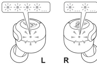
・両方のインジケータがゆっくり 2 回点滅する場合は、両方のイヤホンを一度充電ケースに戻して、約 10 秒たってから、もう一度両方のイヤホンを取り出してください。
