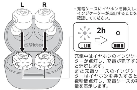
充電中はイヤホンのインジケータが点灯し、充電が完了すると消灯します。また充電ケースのインジケータはイヤホンを挿入すると、数秒間点灯し、充電ケースの残量を表示します。
