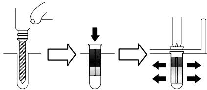
モルタルやコンクリート壁、石膏ボードなど取り付け用ネジでリモコンホルダーを固定できない場合はネジ穴の位置2か所にドリルで直径 6 mm、深さ 30 mm の穴を開け、付属のプラグを打ち込み、取り付け用ネジ2本で固定します。
