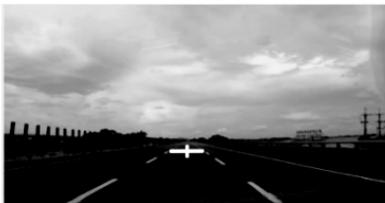
青い十字線を車体から約 10m 離れた位置に上下アイコンで調整してください。左右の車線が、青い横線に接する位置であることを確認してください。
