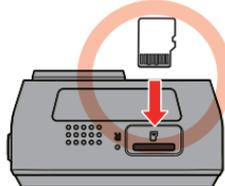
microSD カードのロゴがある面をレンズ側にして、端子面から挿入する
