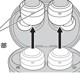
取り出し時にタッチセンサー部に触れないよう注意してください。
