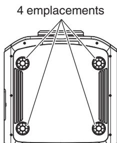
Retirez les quatre pieds situés sous l'appareil et serrez à l'aide des vis (vis M5, 20 à 25 mm (0,8 à 1,0 pouces)).
