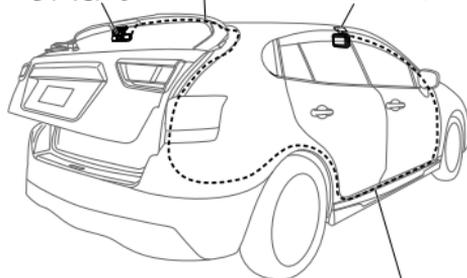
ドア開閉時、ケーブルの挟み込みに注意してください。
