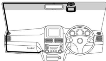
3. 付属のリアカメラケーブルでリアカメラとメインユニットを接続し、配線する → 「ケーブルの引き回し例」(P.19)
