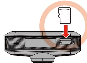
microSDカードのロゴがある面をレンズ側にして、端子面から挿入する
