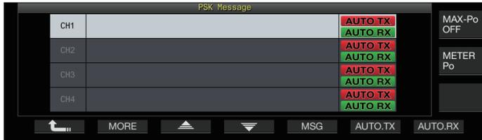
**2 Premere F3[▲]/F4[▼] o ruotare il comando [MULTI/CH] per selezionare il canale per il salvataggio del messaggio RTTY.**
