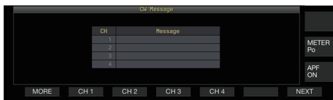
**2 Premere e tenere premuto da F2 [CH 1] a F5 [CH 4], F2 [CH 5] o F5 [CH 8] per selezionare il canale per registrare il messaggio CW.**
