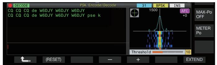
**2 Premere F4 [-]/F5 [+] oppure ruotare il comando [MULTI/CH] per regolare il livello.**
