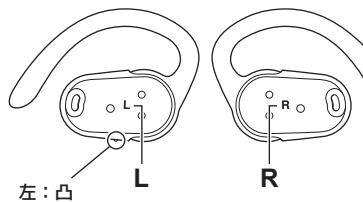
耳と頭部のすき間に差し込み、耳の後ろに回転させて、しっかりとフィットさせてください。
