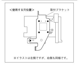
東用パネル 東用パネル 3. 純正のエアコンコントロールパネルからエアコンコントロール部を取り外し、専用パネルに取り付けます。
