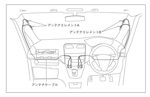
1. アンテナエレメント A、B をフロント ウインドウの室内側に貼り付けます。
