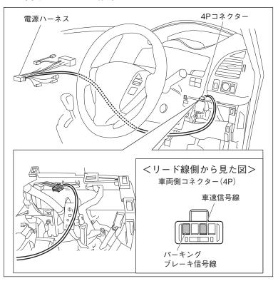
〈パーキングブレーキ信号コード、車速信号コード、 リバース信号コードの接続〉
