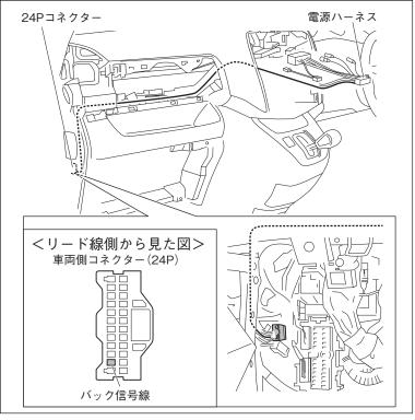
3. 接続図と左図を参照して、グローブボックス奥の 24P コネクターから出ているバック信号線に、中継 コネクターで電源ハーネスのリバース信号コード(紫 /白)を接続します。
