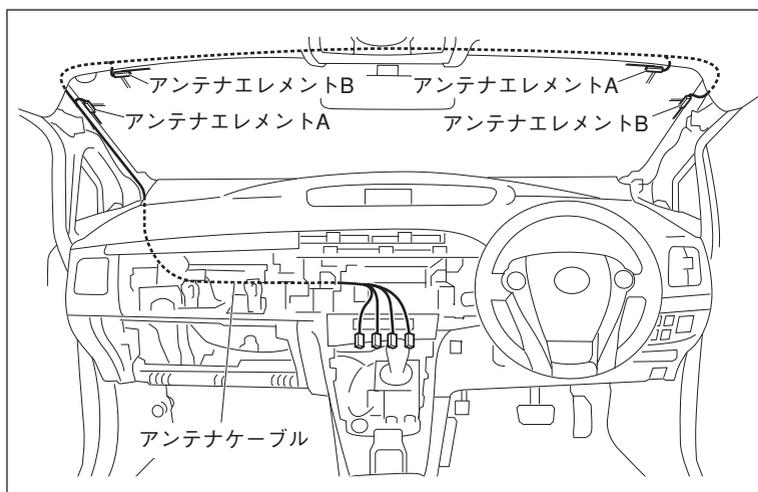
2. アンテナケーブルの給電端子を取り付け後、アンテナケーブルをルーファイニングの中～助手席側 A ピラー～ナビゲーション取り付け部まで配線します。
