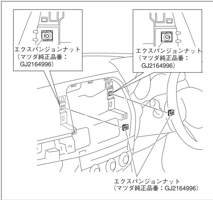
5. エクスパンジョンナット (マツダ純正品番：GJ2164996) を車両に取り付けます。(オーディオレス車の場合)
