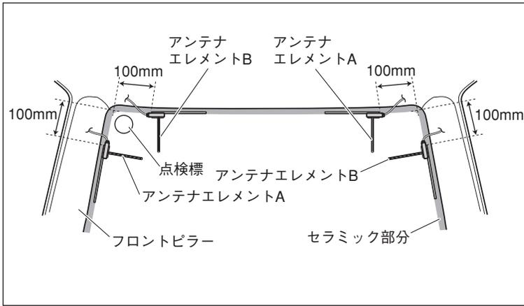
1. アンテナエレメント A、B をフロントウインドウの室内側に貼り付けます。
