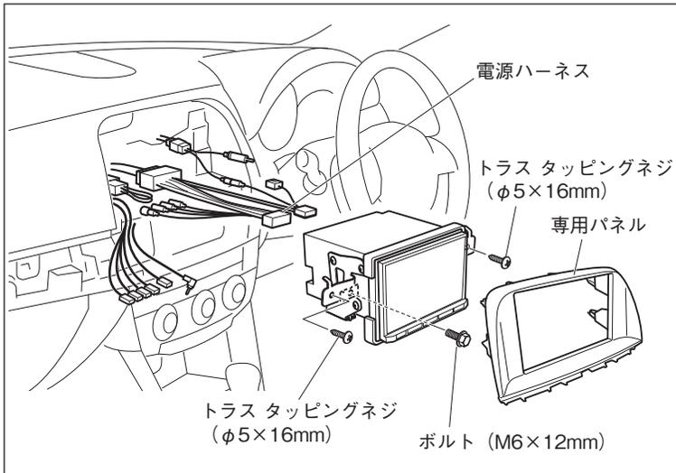
6. 接続図を参照して配線を接続します。
