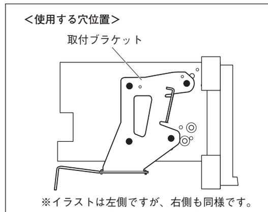
3. ナビゲーション本体に取り付けた取付ブラケットL/Rに、取付ブラケットBを取り付けます。
