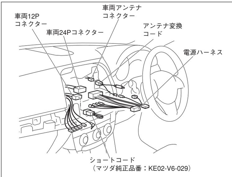
1. 接続図を参照し、車両 24P コネクタと車両アンテナコネクタに電源ハーネスとアンテナ変換コードを接続します。
