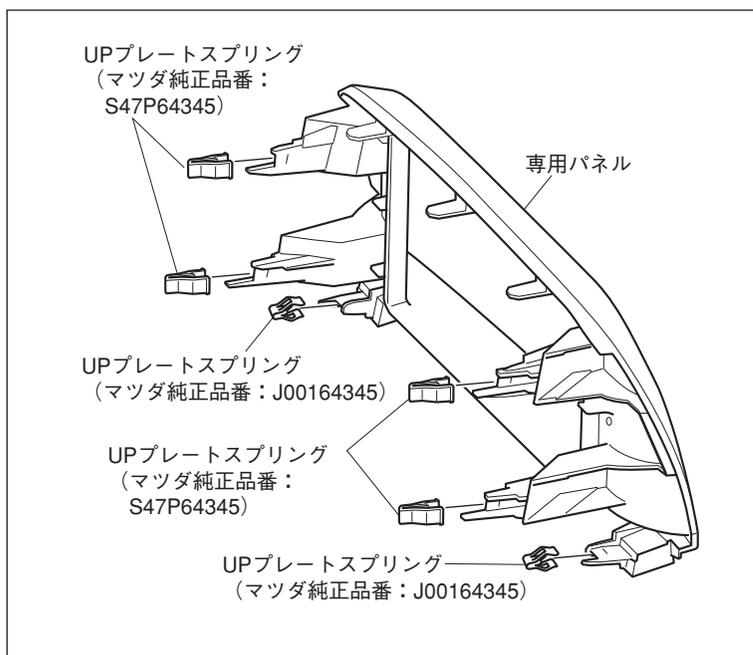
4. UPプレートスプリング（マツダ純正品番：S47P64345）とUPプレートスプリング（マツダ純正品番：J00164345）を専用パネルに取り付けます。
