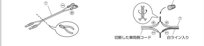
\* 切断前に車両側コネクタの極性を確かめください。(車両によってはコネクタに極性表示があります。)
