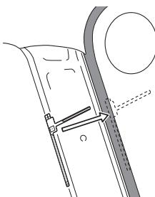
**5.** アンテナエレメントを押さえながらセパレータIをはがし貼り付けます。
