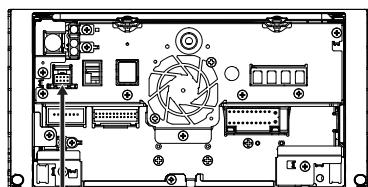
ケンウッド専用端子/汎用RCA変換リアカメラ接続ケーブル
