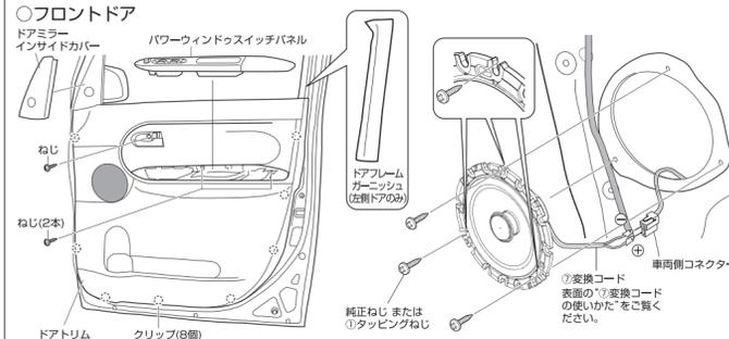
○純正ツイーター位置へのツイーター取付 ※別売ツイーターインナーブラケット SKB-101 3,800円(税抜き)を使用して取り付けてください。
