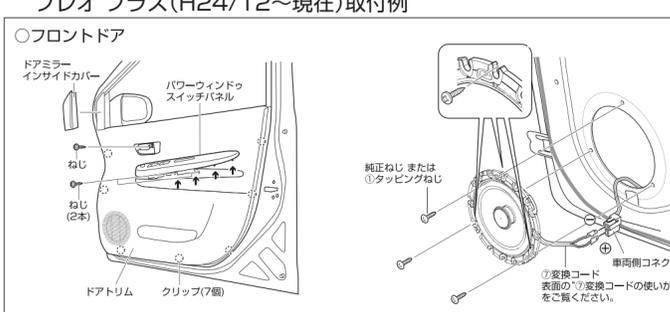
○フロントドア ※別売スピーカー取付キット UA-H70S 4,000円(税抜き) (あるいは高音質ハイブリッドブラケット SKX-201S 5,500円(税抜き))を使用して、取付キットの付属品を取り付け後にスピーカーの取り付けを行ってください。
